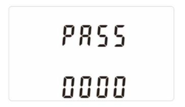
La configuración está protegida por una contraseña, por lo que es necesario introducir la contraseña correcta (valor predeterminado '1000') antes de proceder al procesamiento. Si se introduce una contraseña incorrecta, la pantalla mostrará: Err
