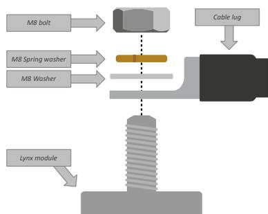
Ubicación correcta del terminal del cable M8, la arandela, la arandela elástica y la tuerca
