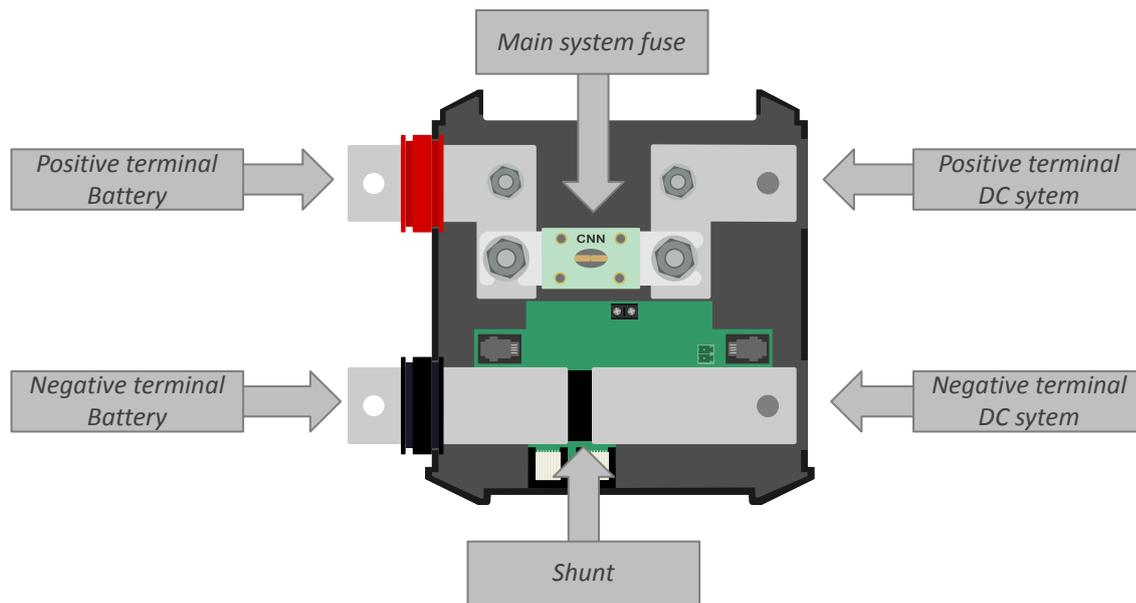
Elementos físicos internos del Lynx Shunt VE.Can
