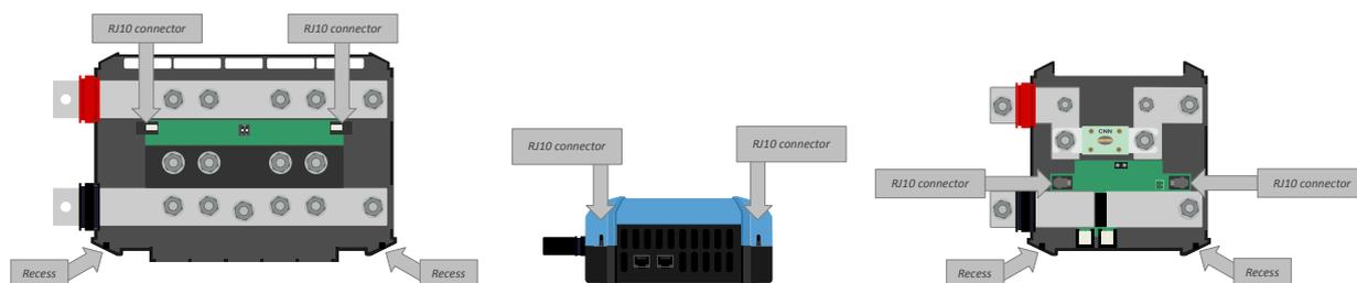
Ubicaciones de los conectores RJ10 y de las ranuras de los cables RJ10 en el Lynx Distributor y en el Lynx Shunt VE.Can
