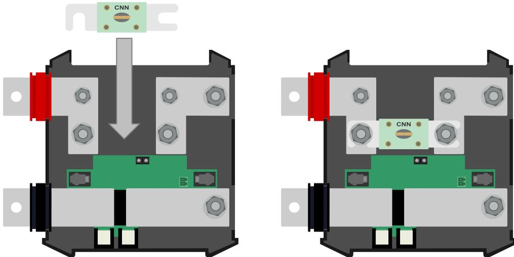
Coloque el fusible CNN en el Lynx Shunt VE.Can.
