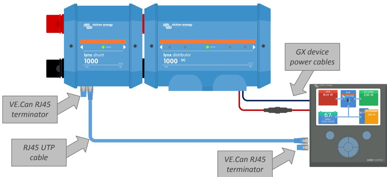
Ejemplo de cableado de Lynx Shunt VE.Can y dispositivo GX
