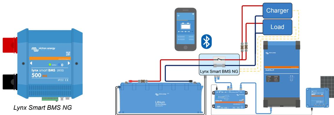
*El Lynx Smart BMS NG apagará cargas y cargadores mediante las señales de “desconexión de la carga” y “desconexión del cargador” y controla el inversor/cargador mediante un dispositivo GX. Si la batería se descarga aún más, el BMS desconectará la batería del sistema CC.*
