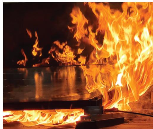
Incendio inducido por arco voltaico bajo un tejado plano solar montado en el laboratorio de ensayos de incendios ZAG
