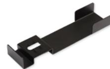
ARC-M02 es adecuado para anchos de raíl de hasta 40 mm y se fija con un tornillo en T de 8 mm o 10 mm. La ArcBox se fija a uno de los tres puntos de montaje, ofreciendo diferentes orientaciones. Esto resulta ideal cuando se instala debajo de un módulo solar de perfil bajo montado en paralelo, por ejemplo en aplicaciones de tejado inclinado. Funciona con Sunfixings, K2 Dome fix, Van der Valk ValkPro y otros.
