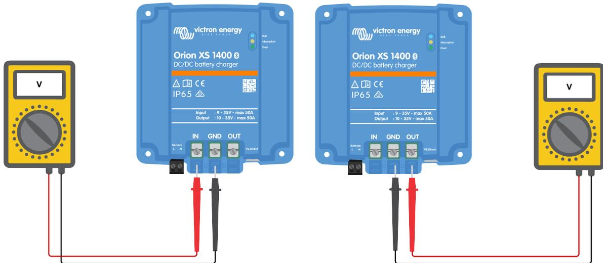
La tensión de la batería se mide en los terminales del cargador para descartar posibles problemas de cableado, fusibles y/o disyuntores situados en la trayectoria entre la batería y el cargador.
