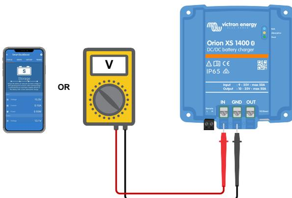
2. Mida la tensión de la batería en los terminales de la batería con un multímetro.
