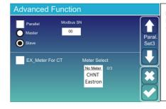
**Ex\_Meter Para CT:** ao utilizar o modo zero-export para CT, o inversor híbrido pode selecionar a função EX\_Meter Para CT e utilizar medidores diferentes, por exemplo, CHNT e Eastron.
