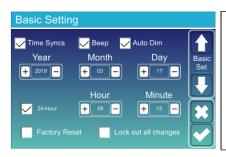
Reposição de fábrica: Repõe todos os parâmetros do inversor. Bloquear todas as alterações: Ative este menu para definir parâmetros que requerem bloqueio e não podem ser configurados. Antes de realizar uma reposição de fábrica bemsucedida e bloquear os sistemas, para manter todas as alterações, é necessário digitar uma palavra-passe para ativar a configuração.
