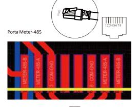
Definição do pino da porta RJ45 da «porta Modbus» para monitorização remota
