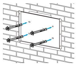
Instalação da placa de suspensão do inversor
