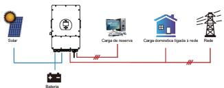
Exportação zero para CT: O inversor híbrido não só fornecerá energia à carga de reserva conectada, mas também fornecerá energia à carga doméstica conectada. Se a energia fotovoltaica e a energia da bateria forem insuficientes, ele utilizará a energia da rede como complemento. O inversor híbrido não venderá energia para a rede. Neste modo, é necessário um CT. A instalação
