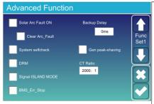
Falha do arco solar ativada: isto é apenas para os EUA. Autoverificação do sistema: Desativar. Isto é apenas para a fábrica.
